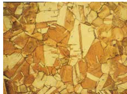
純銅製。塩化第二銅およびアンモニアによるエッチング処理済み試料。拡大率 100倍サンプル
